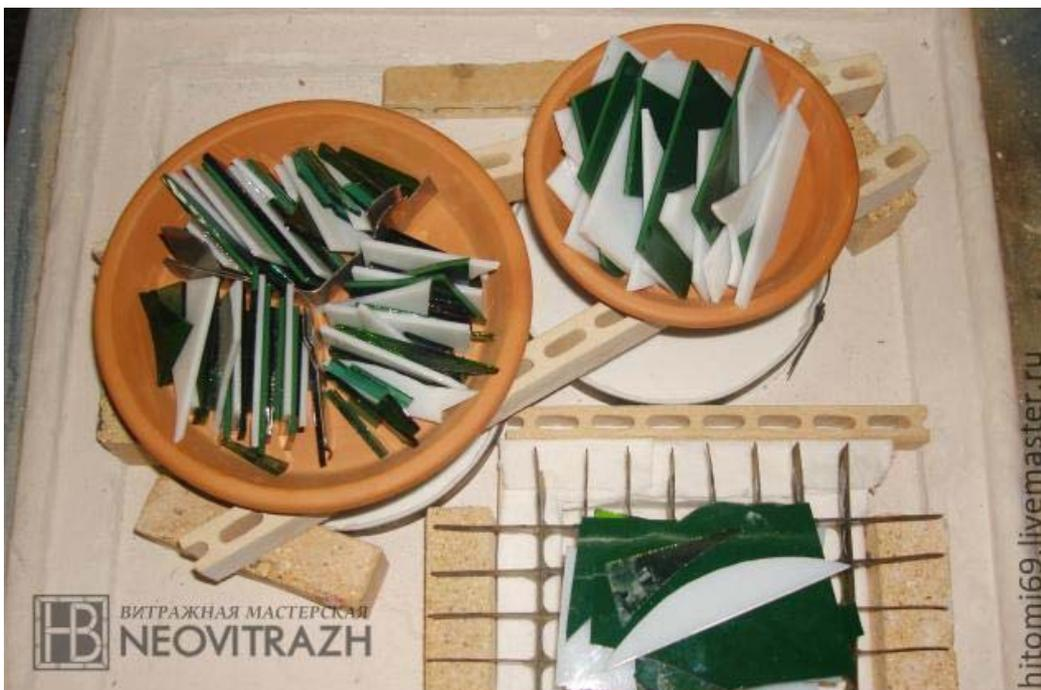
Выдерживаем нагрев печи при 960 С до тех пор пока все стекло в тарелке не вытечет на лещадку. Запасаемся терпением и ждем пока температура в печи под контролем программатора не опустится до 80 С. Моя печь достигает этой температуры за 17-20 часов. Все-таки 9 мм толщины! Нетерпение
