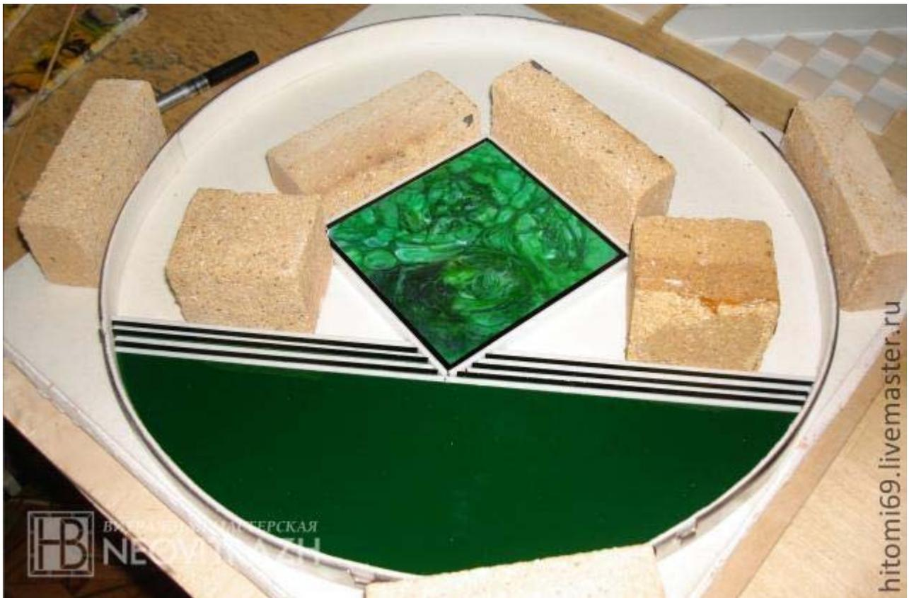
На следующем фото представлена заготовка чаши перед фасонным изгибом. Были проведены следующие работы: полный фьюзинг изделия, распиловка до желаемых габаритов и формы, шлифовка краев и снятие фаски заготовки на шлифовальной машине головками разной зернистости и сечения, термическая полировка с применением SprayA для получения зеркального блеска поверхности и предотвращения растрескивания.
